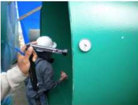
Pengukuran Steel Temperatur
